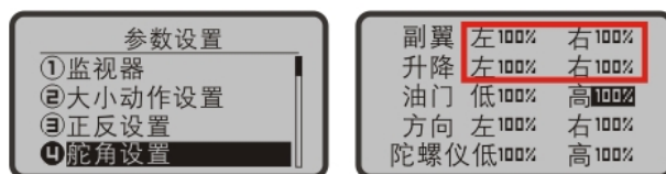
减小安装舵角，并在遥控器上将舵角设为 100%示意图
