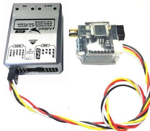
3. OSD 上可以独立显示**动力电电压**与**视频电电压**
