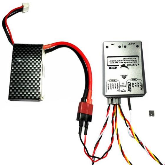
(您也可以选用 Arkbird 带 12V 稳压电流计 (选配配件), 动力和视频部分共用一颗电池。接线如下图所示)
