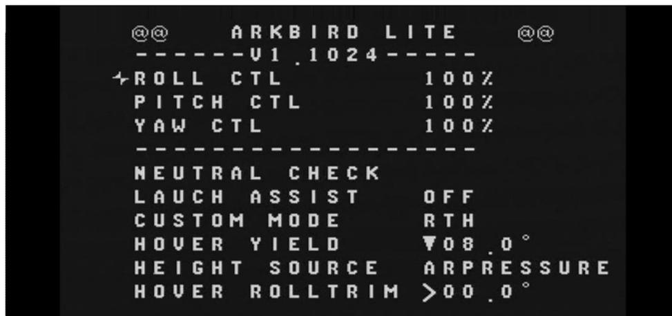
请将遥控器上舵量设为 100%，微调尽量回中，通过调节机械舵孔、CTL 控制量大小改变舵量。
